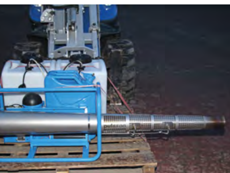
FOT. 8. Zamgławiacz termiczny pulsFOG BIO
