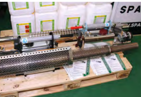
FOT. 9. Zamgławiacz termiczny Masterfog
